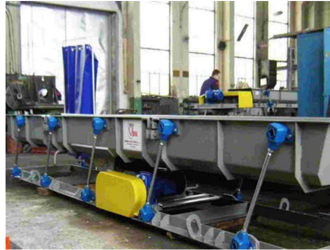
Transportador / alimentador de escombros y residuos
