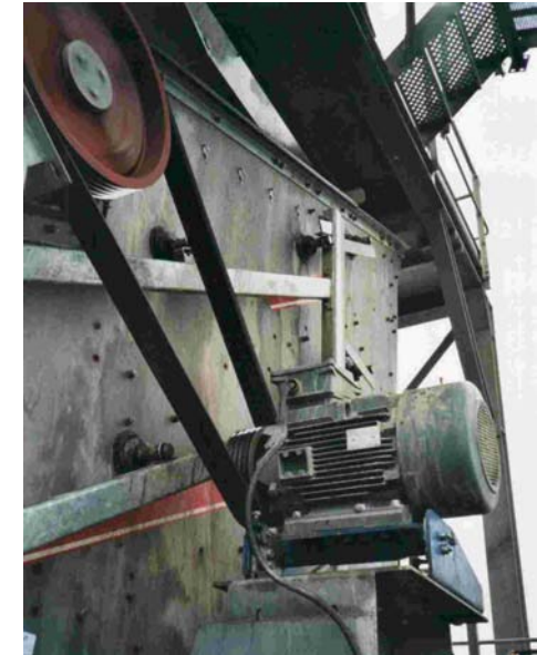
Base de motor en criba de cantera
