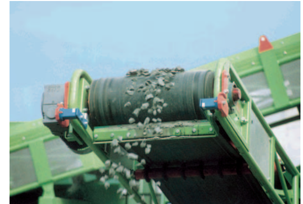
Tensores en rascador de banda
