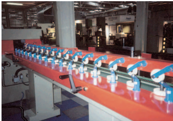
Rodillos guía en maquinaria de corte, madera / cerámicas...
